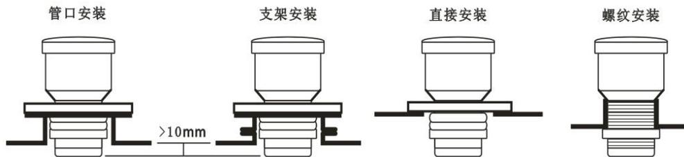
5.1.4 探头的安装应避免其发射的声波通道与容器壁保持如图四所示的理想区域内。图四所示量程与探头安装距离容器壁的区域，如果安装距离小于理想区域下线所规定的距，则应将探头安装在“最小间距”区域之内。如果距侧壁的安装距离仍“最小间距”线的下方，变送器将有可能不能正确地测量物位。见图四
