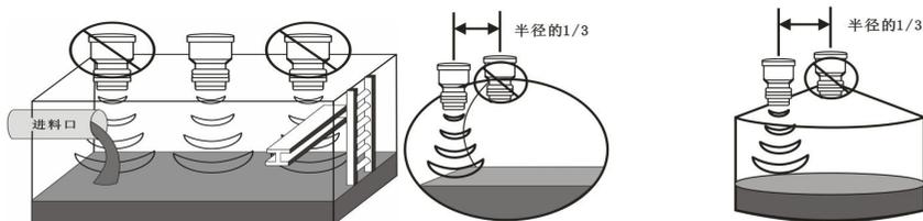
5.1.3 探头可以选择用法兰或是标准的 M60×2 螺纹安装（安装接口与实物为准）。无论是法兰安装或是螺纹安装，或是有无选择锥筒，应该保证探头的底部突出过程接口的底部。图三说明了正确的安装方法。
