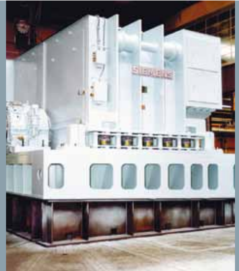
用于一艘巡洋舰上主传动装置的两台 21 MW 电机之一
