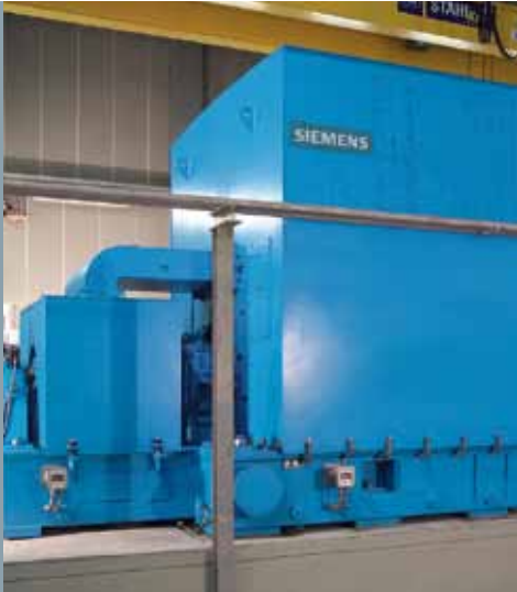
从英国到比利时的一条天然气管线的压缩机站中的 35 MW 电机，转速高达 5040 rpm
