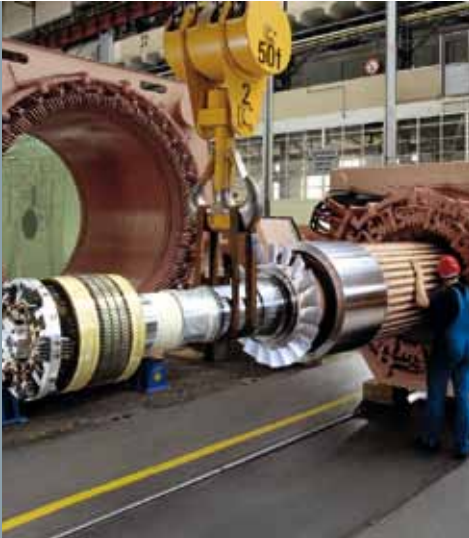
位于挪威哈默菲斯特市的全球第一个全电气化气体液化系统中以 3,600 rpm 转速运转的 65 MW 压缩机电机
