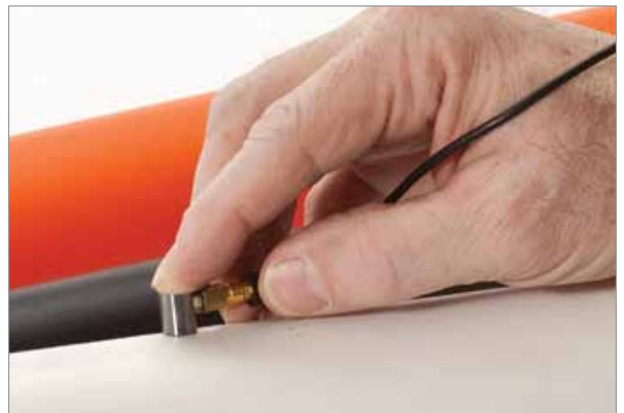
可测量包括塑料、金属、橡胶、玻璃、陶瓷及复合材料在内的很多材料的厚度。
