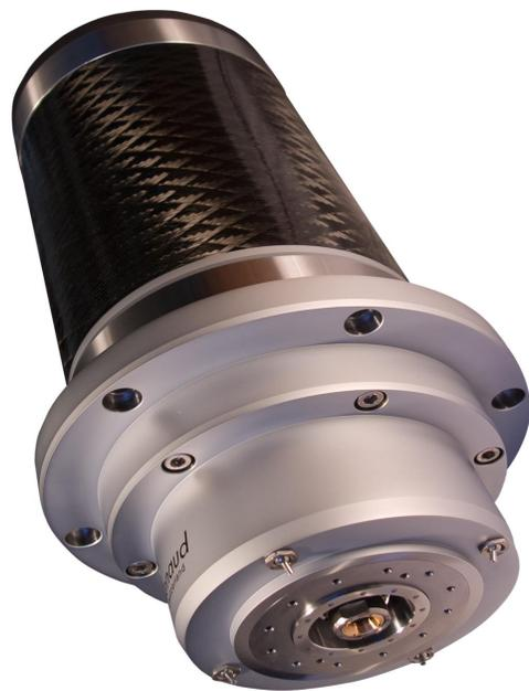
对于传统电机，由于其转速只有几千转速，当需要高转速的时候，就需要采用皮带、齿轮等加速装置而这些结构存在着传动效率低、结构复杂、体积大、振动、噪音等情况。而电主轴可以直接输出超高转速，节省了相关的中间传动机构，避免了上述的弊端。
