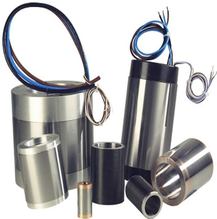
电主轴的电动机均采用异步感应电动机或永磁同步电机,启动时从静止迅速升速至每分钟数万转乃至数十万转,启动转矩大,因而启动电流要超出电机额定电流5~7倍。其驱动方式有变频器驱动和矢量控制驱动器驱动变频器的驱动控制特性为低速恒扭矩,高速恒功率或者恒扭矩。
