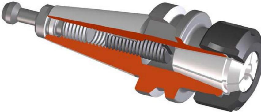
BT、SK\ISO刀柄的锥度为7: 24，转速在10,000r/min左右时，刀柄 - 主轴系统还不会出现明显的变形，但当主轴从10,000 r/min升高到40,000 r/min时，由于离心力的作用，主轴系统的端部将出现较大变形，其径跳增加。刀柄与主轴锥孔间将出现明显的间隙，严重影响刀具的切削特性，因此BT刀柄一般不能用于高速切削
