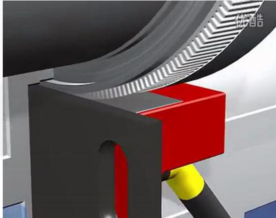
编码器是用来反馈电机旋转的角度（位置）给驱动器，驱动器收到反馈信号后再来控制电机旋转。形成闭环控制以达到精确控制伺服电机旋转的位置，速度。
