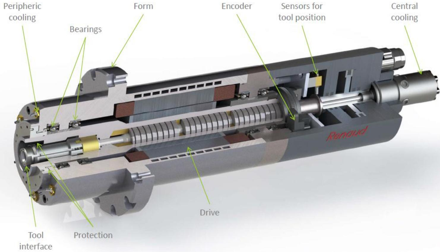
电主轴由定转子、旋转轴、轴承、主轴壳体、冷却水套，拉刀机构、旋转接头、编码器等各种传感器组成，另外配套驱动模块和冷却装置。电机的转子采用压配方法与主轴做成一体，主轴则由前后轴承支撑。电机的定子通过冷却套安装于主轴单壳体中。主轴的变速由主轴驱动模块控制，而主轴单元内的温升由冷却装置限制。在主轴的后端装有测速、测角位移传感器，前端的内锥孔和端面用于安装刀具。
