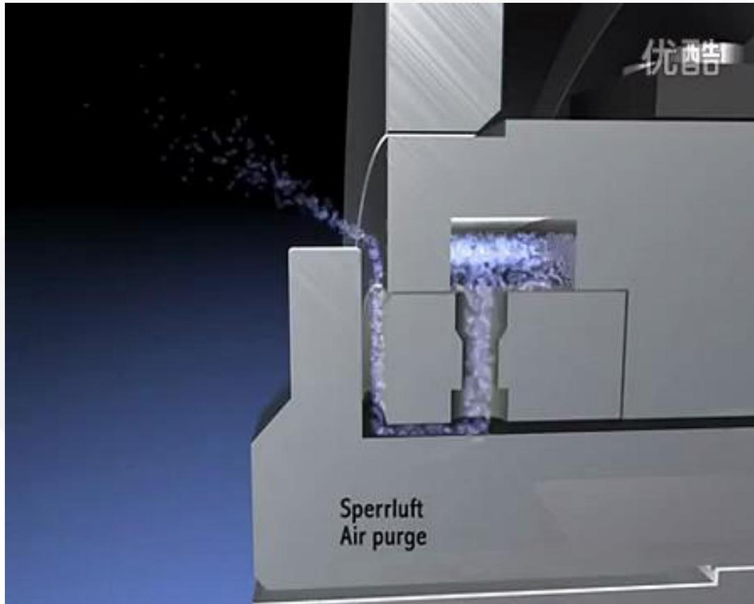
在主轴运转和停机半小时内要一直吹压缩空气，以防止切削液进入主轴内部，保护主轴轴承；吹走转子定子部位的水雾，以保持主轴内部的干燥。
