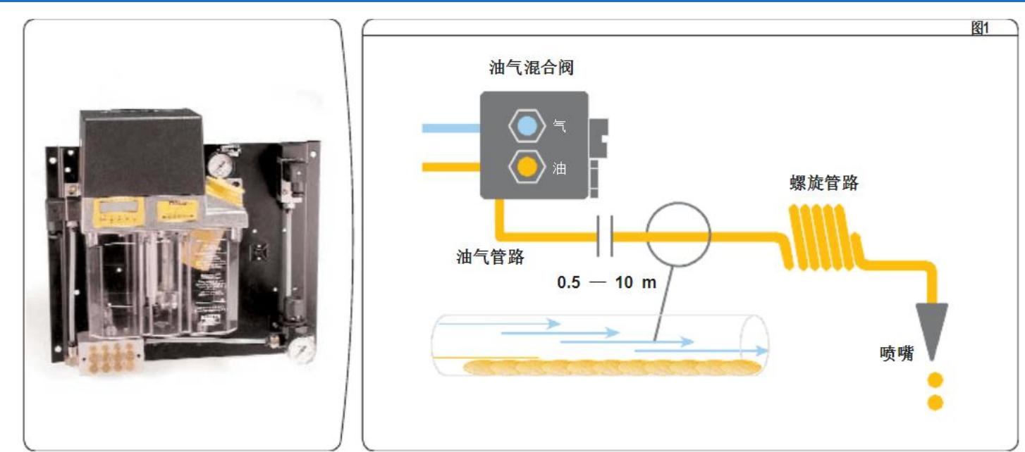
电主轴油气润滑装置通俗的解释就是，油跟随气体的流动而往前运动。气体在运动过程中，会带动附着在管壁上面的少量油滴进入到两边的传动轴承，喷洒到摩擦面上的是带有油滴的油气混合体。这种润滑装置不仅经济、环保、快速、高效，更重要的是油滴适中，不会造成因油量过多轴承无法散热，也不会造成因油量过多，轴承在高速旋转过程中产生背压，避免了电主轴负载增加，更不会产生窜动现象。
