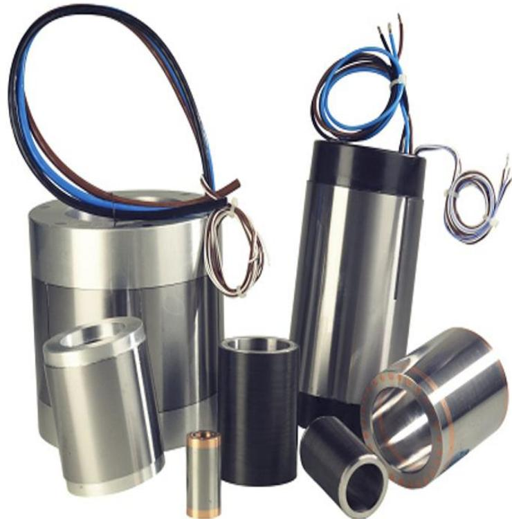
电主轴的电动机均采用异步感应电动机或永磁同步电机,启动时要从静止迅速升速至每分钟数万转乃至数十万转,启动转矩大,因而启动电流要超出电机额定电流5~7倍。其驱动方式有变频器驱动和矢量控制驱动器驱动变频器的驱动控制特性为低速恒扭矩,高速恒功率或者恒扭矩。
