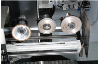
抽屉式3工位砂轮库 Drawer 3-package wheel changer 最大砂轮直径 125mm Grinding wheel max diameter:125mm
