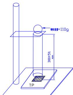
测试结果：电容式触摸屏模组没有发生破裂，功能正常
