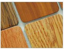
**铝塑复合板简称铝塑板**是由经过表面处理并涂装(用氟碳涂层或聚酯涂层)的铝箔作为表层、聚乙烯材料作为芯层,并通过 热复合工艺生产而成的新型装饰材料;主要应用于建筑幕墙、外墙装饰与广告、室内装饰等。
