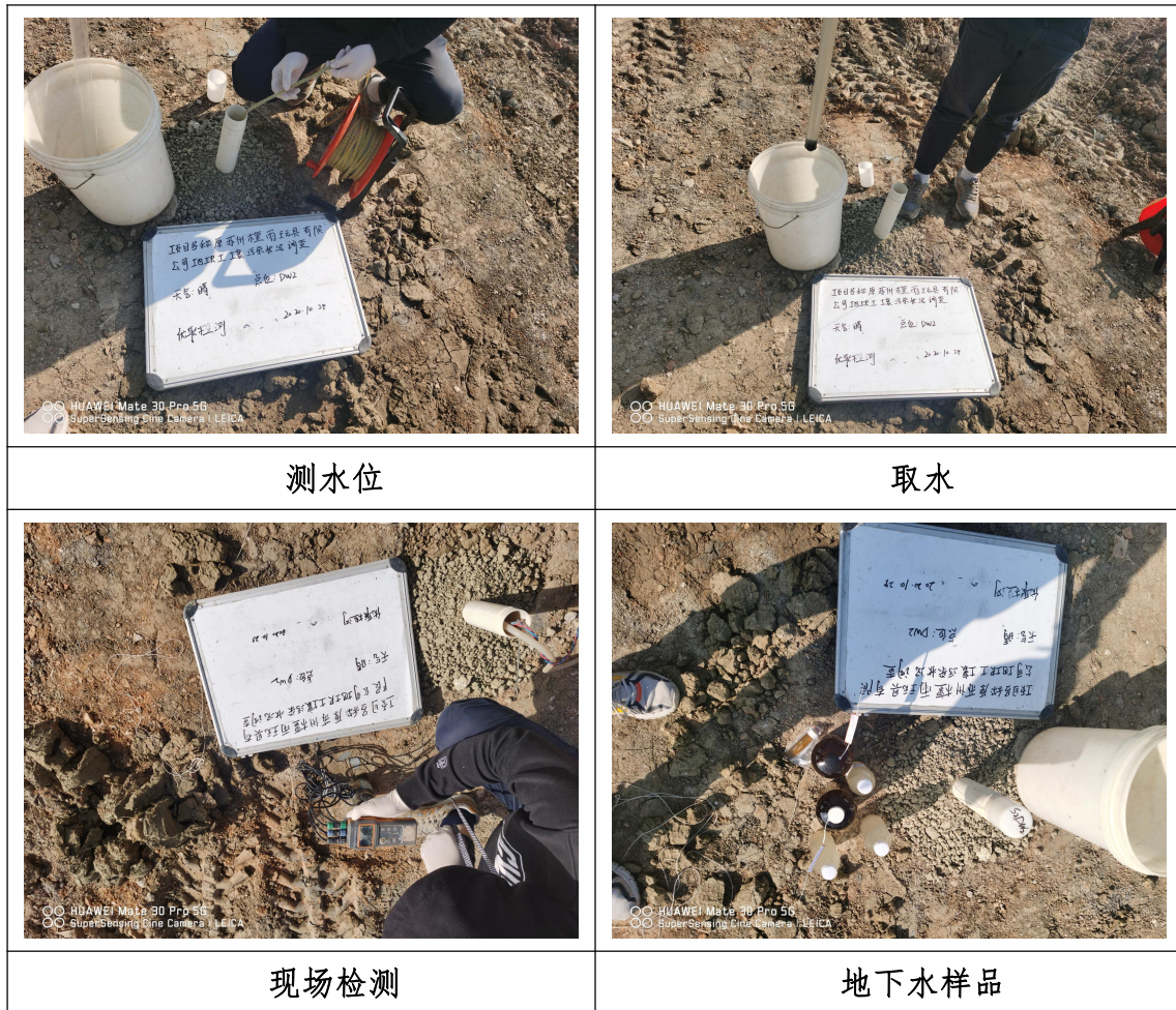
图 3.3-3 地下水采样现场图
