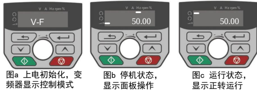
图 4-3 变频器初始化、停机、运行状态时的显示
