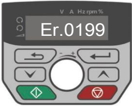
图 4-4 故障告警显示状态
