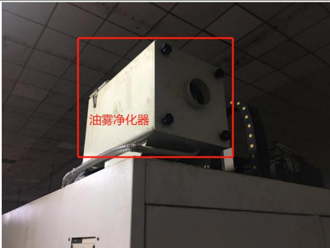
图 3-1 油雾净化器
