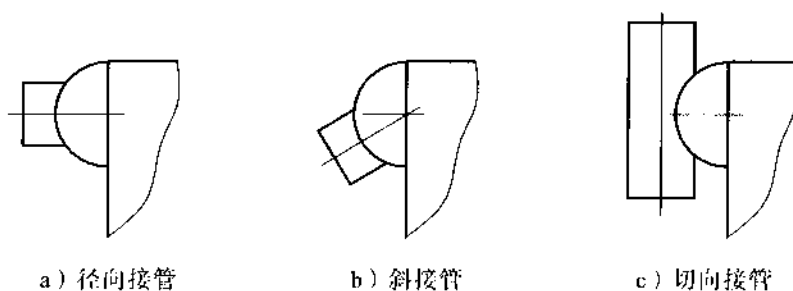
图 5.2 典型的封头/接管形式
