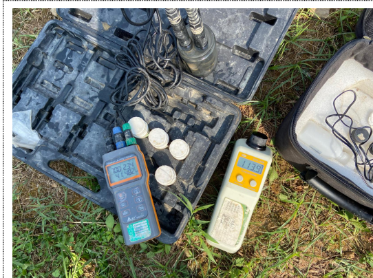
附图 11 地下水现场检测
