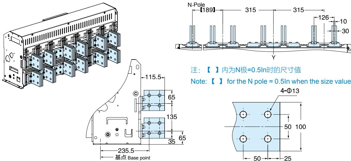
**垂直后连接7500A(只提供垂直方式)、8000A(只提供垂直方式)**
