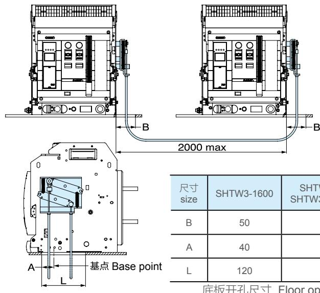
两台叠装断路器的杠杆联锁（“电路图”及“可能的运行方式”同钢缆联锁）
