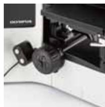
用于旋转电动物镜转换器的手动开关
