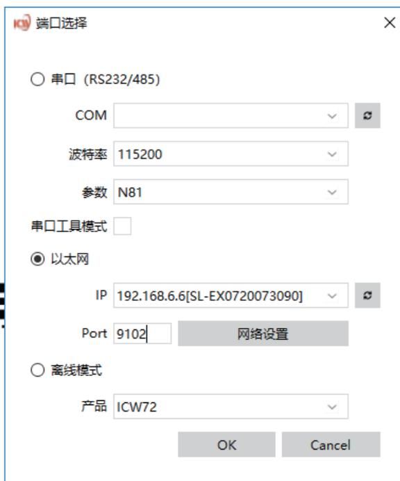
备注：软件支持网口和串口的连接方式,选择当前所使用的通讯方式进行连接。
