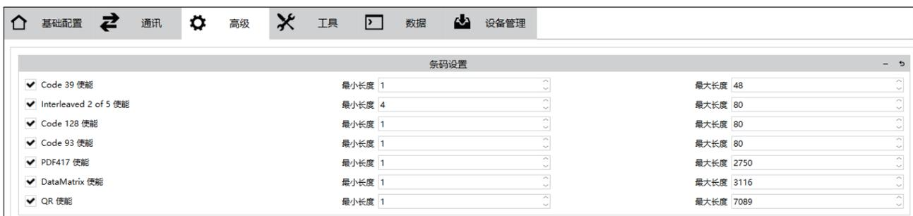
可以根据需求设定读取码制的字符位数长度,仅当所读取的条码 / 二维码长度在设定范围内时,读码器才输出读码内容。
