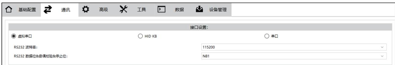
**接口设置：**可选择通讯接口方式为虚拟串口、USB Keyboard、RS232 串口或以太网,如下图所示
