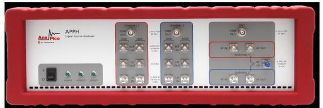
**APPH系列**是一款高性能相位噪声分析仪和VCO测试仪，其不同型号的频率范围覆盖了从1MHz到7、26、40、50或64GHz。它的本底噪声低至**-190dBc/Hz**并提供了一系列相位噪声分析仪必不可少的分析和测量功能，可用于评估信号源（晶体振荡器、VCO、发射器、锁相环、频率合成器等，范围从VHF到微波频率），以及有源和无源非自振设备，如放大器或分频器等。这些功能包括绝对和加性相位噪声、幅度噪声、脉冲、抖动和艾伦偏差、瞬态分析、VCO表征和频谱监测等。APPH系列标配FPGA互相关运算频谱引擎的混合信号系统架构可实现非常快速的信号处理和超低相位噪声测试灵敏度。APPH系列同时内置可编程电源和低噪声调谐电压使该装置极其灵活且易于使用。
