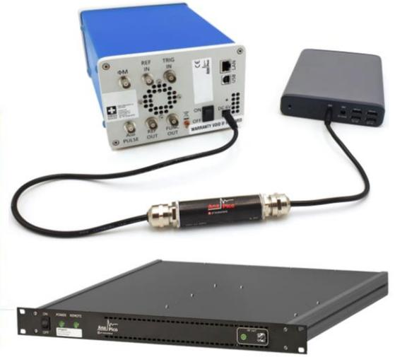
**APSINXXG系列**是AnaPico目前最具性价比的微波信号发生器，该系列产品一共拥有四个型号，它们的频率范围分别覆盖9kHz至6GHz、12GHz、20GHz和26GHz（最大可设30GHz）。
