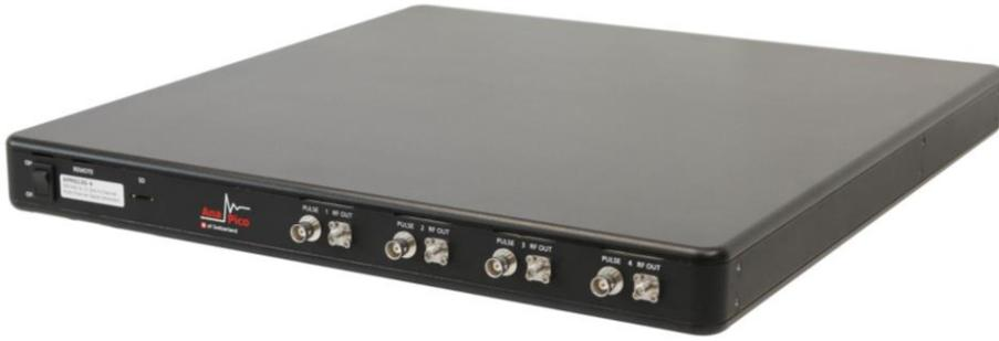
**1U标准机箱，4个独立控制且相参输出通道，40GHz最高输出频率，90dB通道间隔离度，0.17°@5H相位漂移，相参切换与相位记忆**
