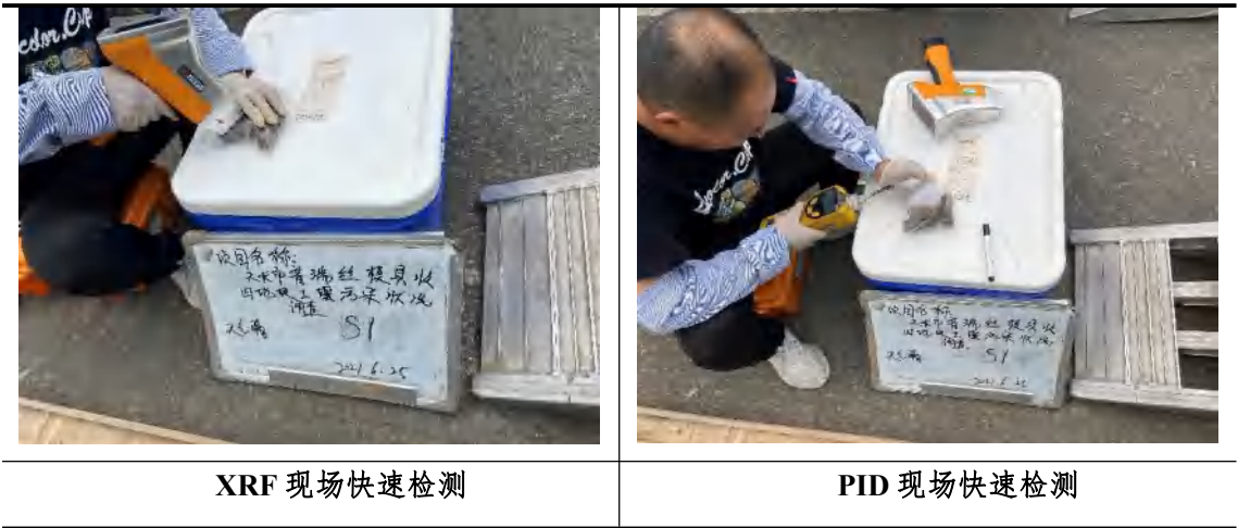
图 4.3-5 现场快速检测
