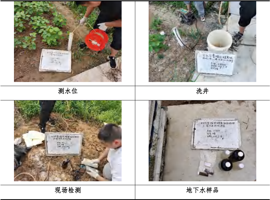
图 4.3-3 地下水采样现场图
