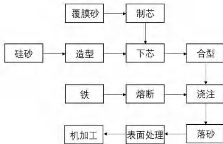
图 3.1-12 铸铁缸盖工艺流程图
