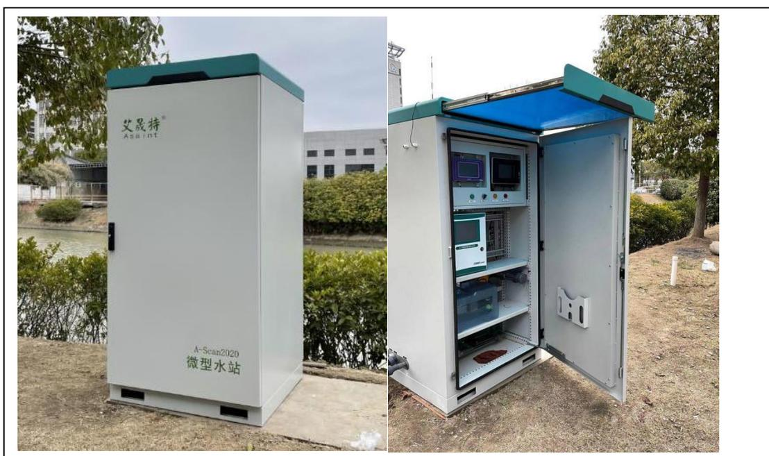
智慧渔业水质自动监测站将采水配水单元（需外加水泵）、控制单元、测量单元、数据处理单元和数据传输单元集于一体，整体占地面积大大缩小（仪器占地面积为0.9 米\*0.9 米，四周预留1 米设备调试空间），外加多种辅助自动清洗设备延长设备使用寿命，减少设备维护量，是一种新型智能水质监控系统。
