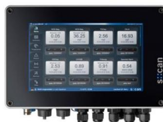
最直观的触摸界面，使用现代的、操作便捷的方法，如同移动电话和掌上电脑独立的硬件配置，传感器和监测站可以通过任何相匹配的设备连接到互联网，通过任何浏览器运行。比如：PC，笔记本，掌上电脑或手机。
