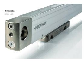
X、Y轴直线电机,具有超高推力密度,低顿力,配有海德汉全闭环高精度直线光栅尺,直线光栅尺具有测量方向上的高刚性,热特性好等 特点,全闭环控制模式能消除潜在的多个误差源,从而保证了机床高精度定位和高速加工时的稳定性,且长期持久。Z轴采用高扭矩输出 NUM伺服电机,可配直线轴光栅尺。
