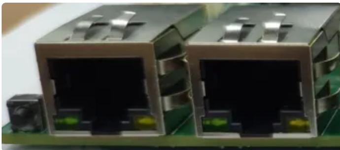
开发板2路千兆以太网接口，上图左边接口为 eth0，右边接口为 eth1。以太网接口默认支持DHCP，只需要将以太网接口连接路由器即可为开发板动态分配 IP 地址
