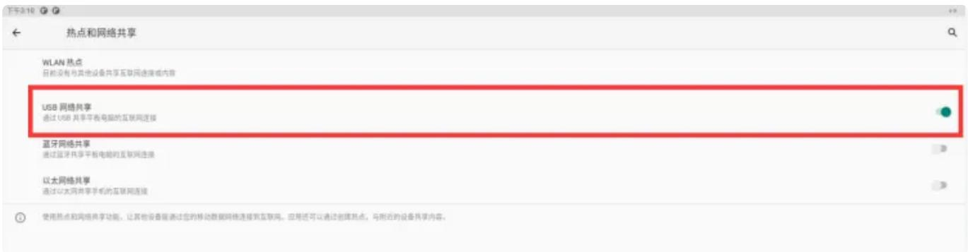
开发板插入可上网的网线后，USB数据线一头插入到板子OTG口（如下图所示），另一头插入电脑，电脑即可共享板子的互联网连接
