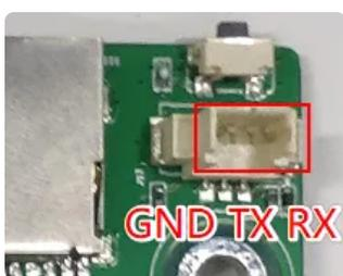
调试串口为 TTL 电平，开发板接口为 MX1.25 接线端子，使用 USB 转串口模块连接 PC 调试终端。
