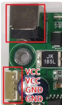
开发板12V @2A DC供电，有 DC 母座和 PH2.0-4 排针两种电源输入接口，接口位置如上图所示。
