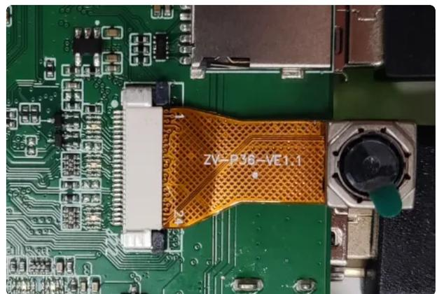
OV8858摄像头 (硬件配置1.2V电压)
