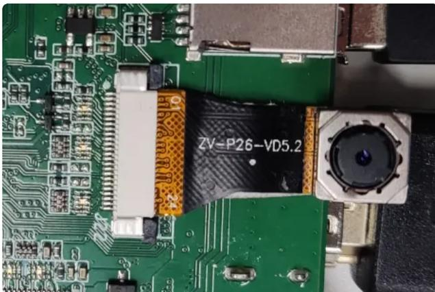
OV5648摄像头 (硬件配置1.5V电压)
