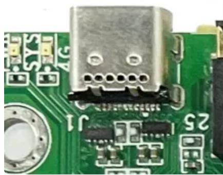
图10. IDO-SBC3968 TypeC接口
