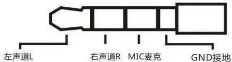
图7. IDO-SBC3968 国标耳机示意图
