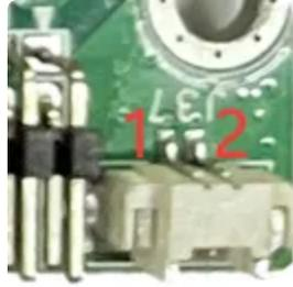
主板留有一个RTC电池接口，采用1.25mm 2P座子。保证主板在断电情况下，时间保持正常工作。
