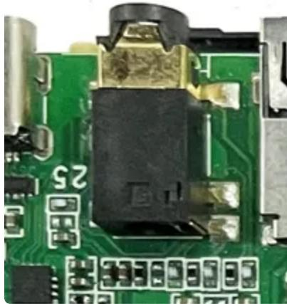
图6. IDO-SBC3968 耳机接口示意图
