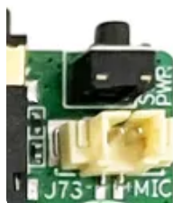
图20. IDO-SBC3568-V1 Power_on按键
