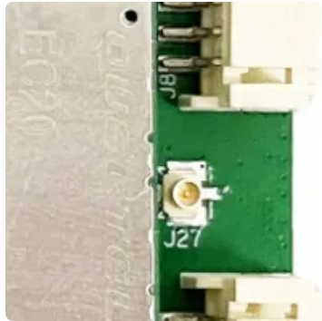
图16. IDO-SBC3568-V1的IPEX一代天线座
