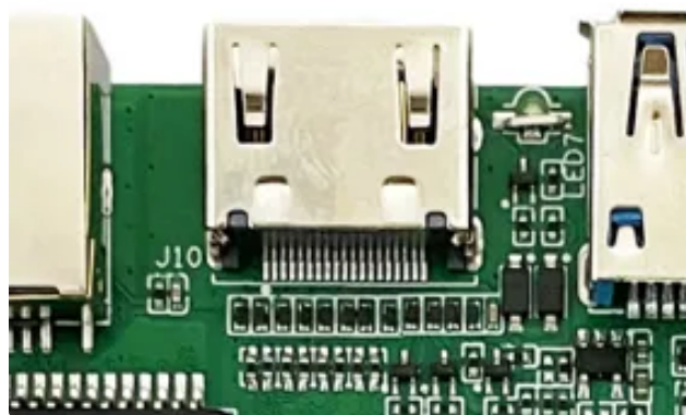
图12. IDO-SBC3568-V1 HDMI-A接口示意图
