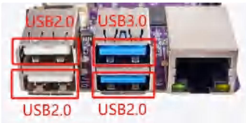
**注意：**USB TYPE-C(J7) 作为系统烧录调试口，和双层USB 3.0的下层接口复用了，通过SW4拨码开关进行切换。
