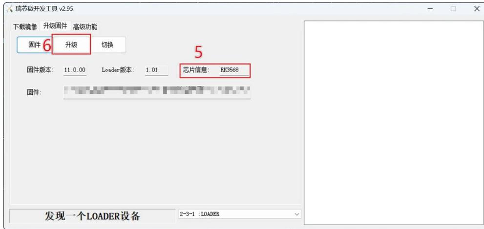
固件下载（预计两分钟），下载完成后右边会有下载成功提示。主板完成烧录后等待系统启动完成并且软件底部会显示出“发现一个ADB设备”，代表烧录成功，如下图所示：
