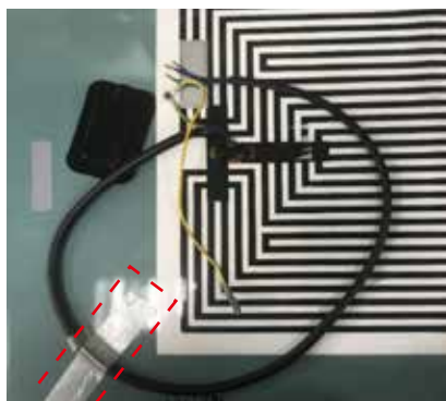
使用8915纤维胶带固定卫浴镜背面的线束
