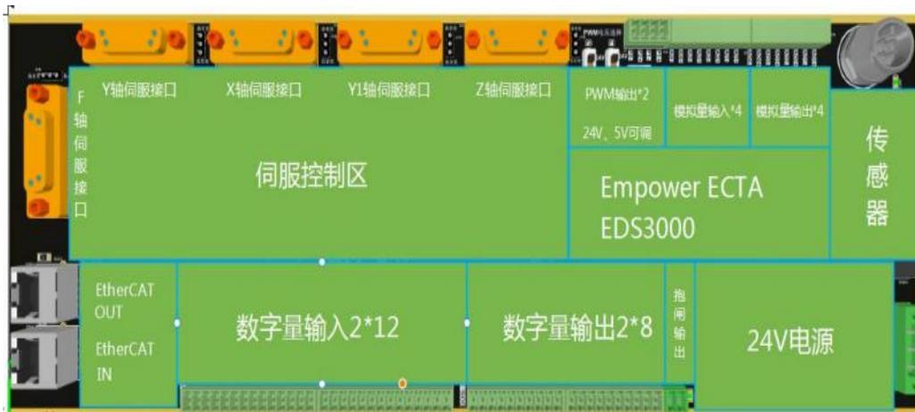
板卡外形尺寸为 122mm\*348mm，可以组装于模组架上以便固定在 DIN C45 导轨上使用。
