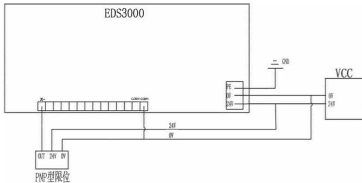
其中，COM1 接 24V 时，输入信号低电平有效；COM1 接 0V 时，输入信号高电平有效。以触点开关举例说明。
