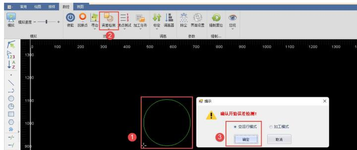
运动完成后，系统会将编码器反馈的位置在软件上画出来，使用测量可以看到伺服的误差。此误差可作为调整伺服参数的依据。
