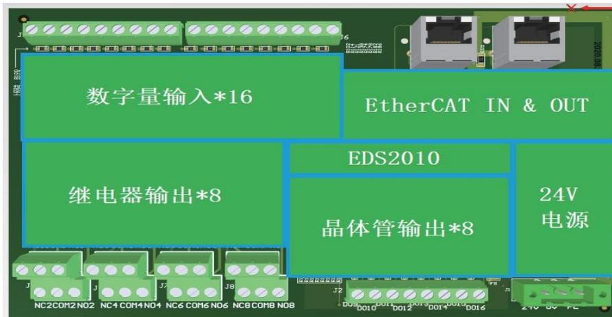
卡外形尺寸为 185mm\*122mm，可以组装于模组架上以便固定在 DIN C4535 导轨上使用。功能布局如下图所示。
