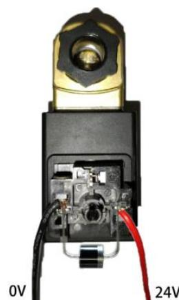
注意：接二极管时需要注意二极管的阴阳极，直流电源 24V 接二极管阴极，直流电源 0V 接二极管阳极；若接反会导致短路。
