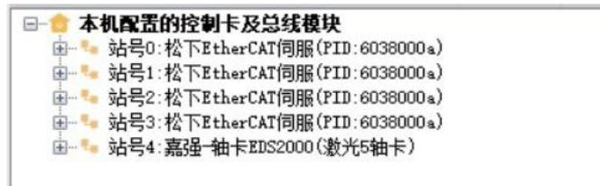
2) 将第一个伺服 (站号 0) 点开, 连接为 Y 轴; 第二个伺服 (站号 1) 点开连接 X 轴; 第三个伺服 (站号 2) 点开, 连接为 Y1 轴; 第四个伺服 (站号 3) 点开, 连接为 Z 轴。
