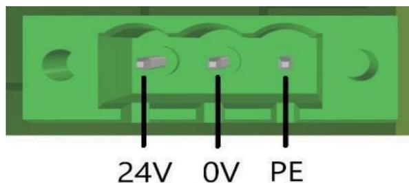
EDS2010 板卡电源接口需要连接外部 DC24V 开关电源，其中输入端子 24V、0V 和 PE 分别接外部开关电源的 24V、0V 和保护地。
