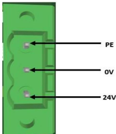
EDS3000 板卡电源接口需要外部连接 DC24V 开关电源，其中输入端子 24V、0V 和 PE 分别接外部开关电源的 24V、0V 和保护地的输出接口。
