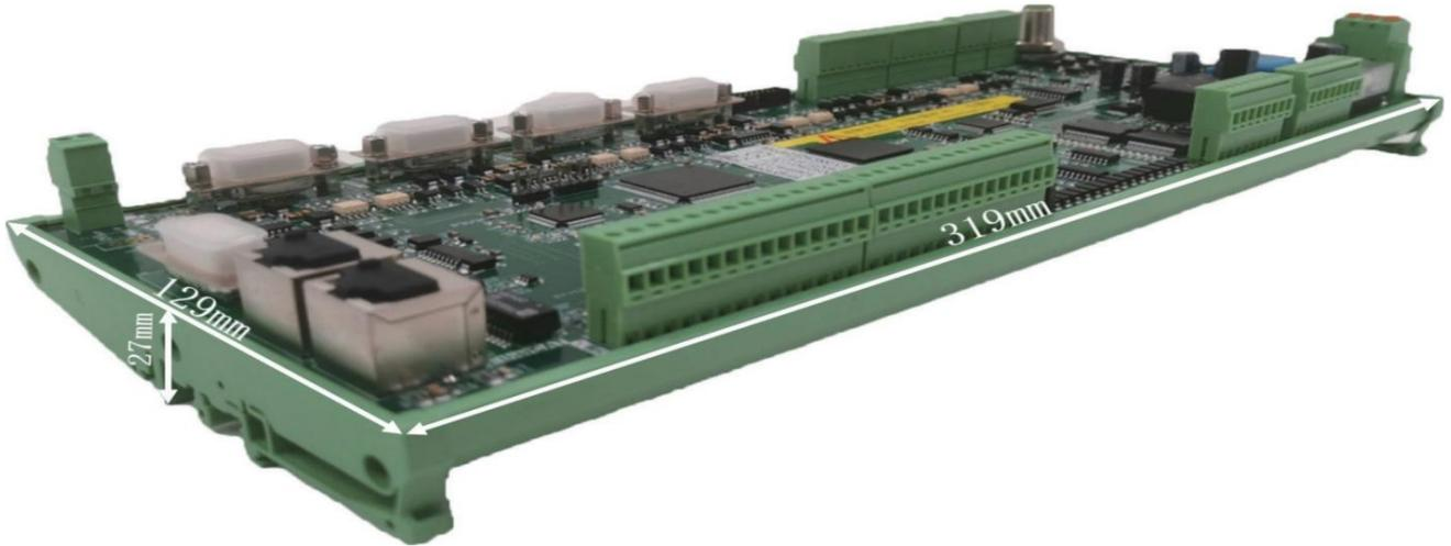
EDS2000 是基于 EtherCAT 总线的从站接口板，包含丰富的 IO、运动控制、激光随动接口和资源，特别适用于激光行业的信号采集与运动控制场合。
