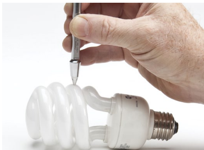
高分辨率软件选项可进行分辨率高达0.001毫米的厚度测量。
