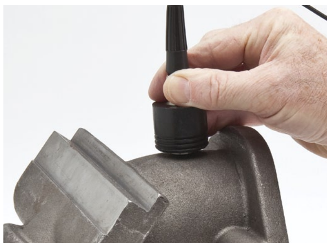
高穿透软件选项可以对很多铸造金属部件及声波衰减性很强的材料进行测量。
