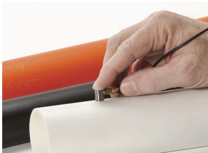
可测量包括塑料、金属、橡胶、玻璃、陶瓷及复合材料在内的很多材料的厚度。
