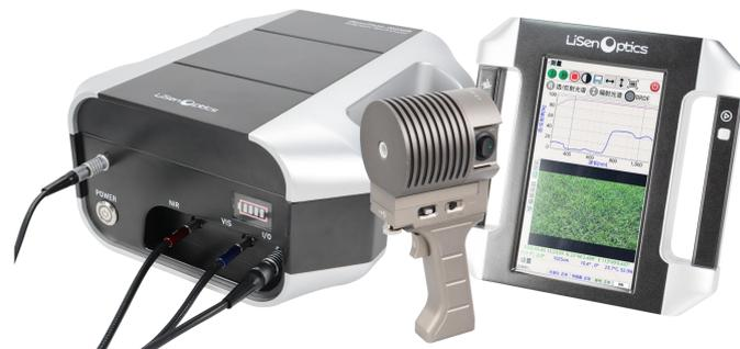
iSpecField-WNIR 便携式地物光谱仪光谱范围 200-2500nm, 独有的光路设计, 噪声校准技术、可以实时自动校准暗电流, 采样了固定全息光栅一次性分光, 测试速度快, 最短积分时间最短可达 10 微秒, 测试动态范围广, 同时采用双路高像素探测器同步测量, 光谱数据分辨率高, 广泛应用于矿物鉴定、土壤研究、遥感测量、农作物监测、森林研究、海洋学研究和矿物勘察等各领域。
