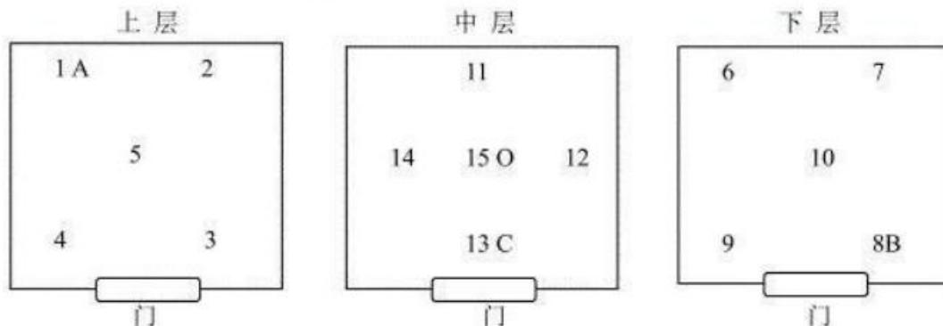
图2 设备容积大于 $2\text{m}^3$ 布点示意图
